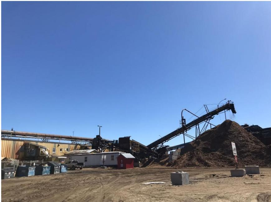
*Figure 4 - Evacuation de l'écorce hors de la scierie pour aller alimenter les fours des séchoirs*
