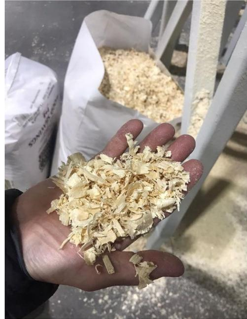
Figure 9 - Litière équestre de grande dimension issue de la planure de bois après rabotage des planches
