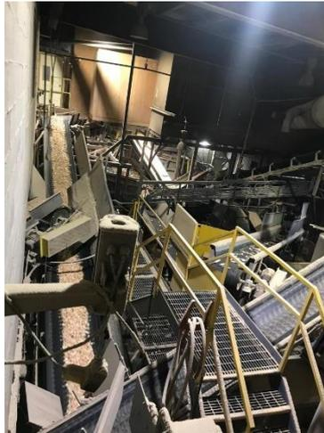
Figure 6 - Transport des copeaux de bois issus des résidus de bois rond une fois le billon transformé en planche
