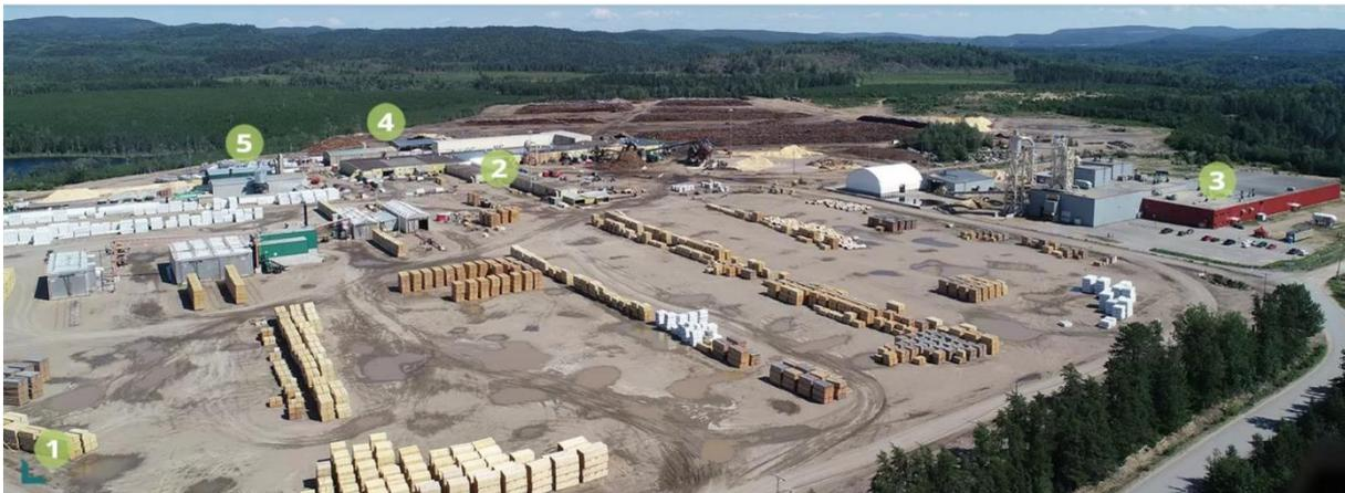
Figure 2 - Site industriel de Boisaco : 1. Administration de Boisaco ; 2. Usine de sciage et rabotage ; 3. Fabrication de panneau de fibre ; 4. Fabrication de litière équestre ; 5. Fabrication de granulés pour poêles à bois (source : site internet Boisaco).
